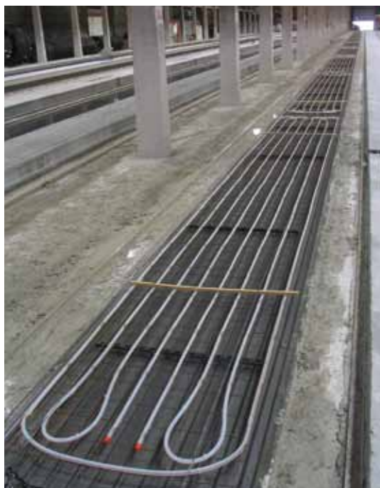
Abb. 2 Module für die KlimaDecke auf der Produktionsbahn
